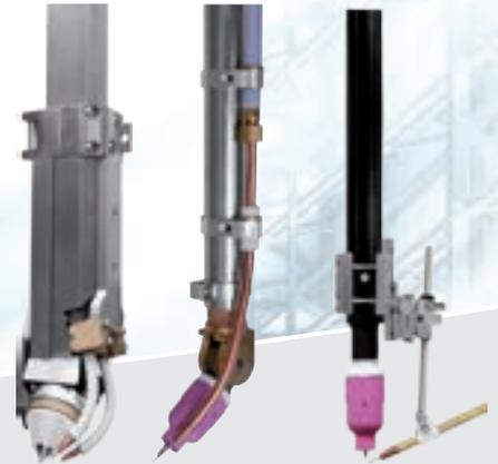
/ Plattierbrenner für Compact Cladding Cell, Conventional Cladding und ETR-S mit **FPA 9000** oder **HMI-T10** Systemsteuerung.
