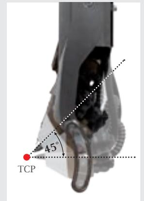
/ Der Brennerkopf ist horizontal (15°) und vertikal (45°) schwenkbar. Dabei bleibt der TCP (Tool Centre Point) unverändert.
